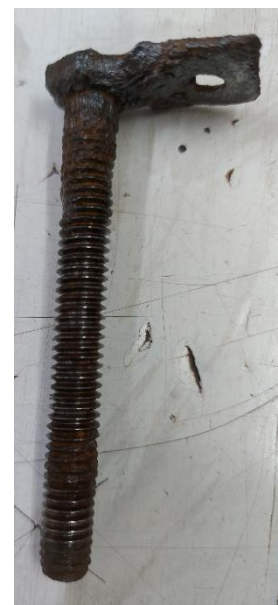
איור 22 - ימין, מבט מקרוב על הבליה הרבה בפיני הברזל. שמאל, מבט על לוח העץ הלבד, מסגרת פרופיל הפליז וגומות הפינים
