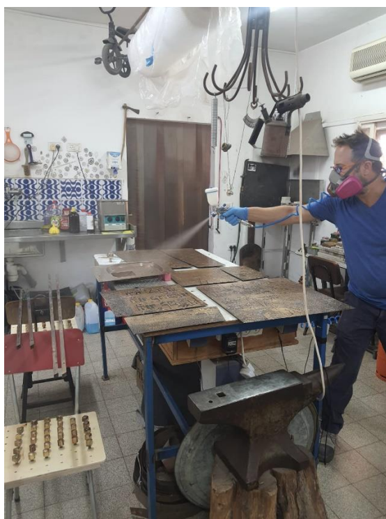
איור 17 – ימין, התזת ציפוי מגן מבוקר בחדרון הצביעה. שמאל, התזת שכבה שנייה על מכלול חלקי נתכי הנחושת
