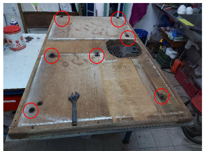
איור 6 – ימין, מראה גוף הדלת עם 7 ברגיי ההידוק(מסומן אדום). שמאל, מראה הגוף הנפרד, מוצב הפוך לצורך ניקיון
