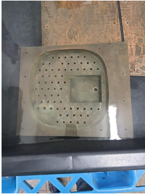
איור 13 – מימין לשמאל, הכנסת לוחות התבליט הירקרקות לאמבט התמיסה ומראה פני השטח המשתנים באיטיות ועליהם נחשפים ומתגלים פרטי התבליט עקב הסרת מלחי הקורוזיה.
