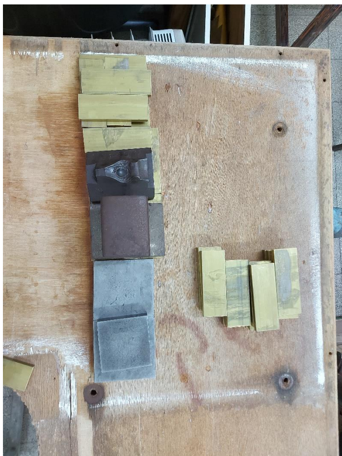
איור 14 – ימין, הדבקת שכבות גוף הדלת מהעץ וכליבתן. שמאל, משקולות על שכבת הפורניר לאחר החדרת דבק בעזרת מזרק
