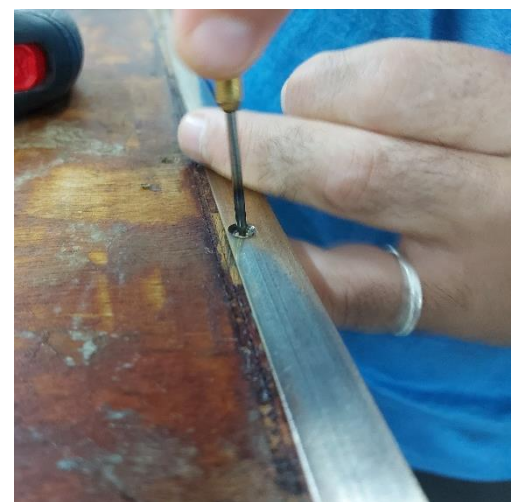
איור 20 – מימין לשמאל, מרכז חור ההברגה בתותב בעזרת דקר, הברגת בורג עץ חדש מפליז, מראה מקרוב של הבורג המהדק את מסגרת פרופיל הפליז לעץ הלבוד.
