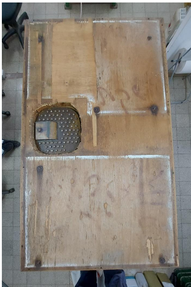
איור 26 – ימין, לוח העץ הלבוד אליו חובר התבליט מונח הפוך ובולטים ממנו שבעה פני התבריג מסומנים אדום. שמאל, הנחת גוף העץ על גבי לוח עץ התבליט והידוק תבריג הפינים להצמדה מלאה
