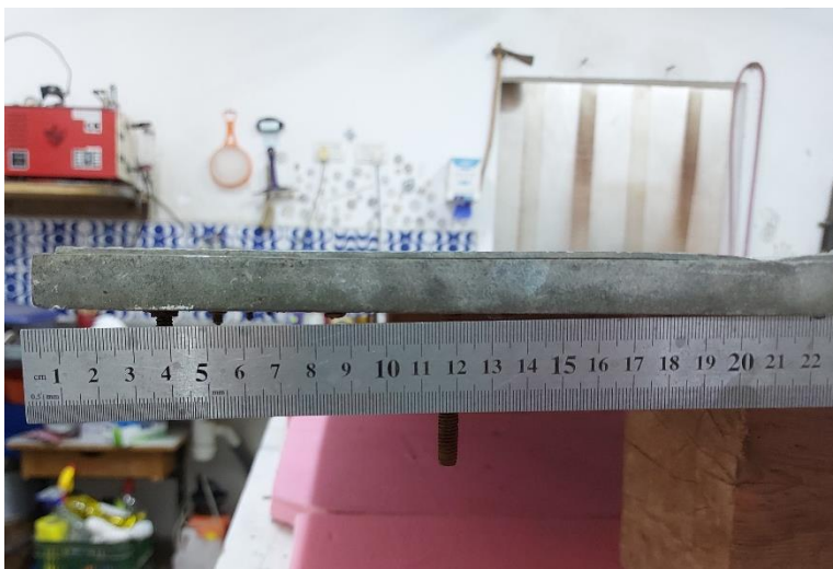
איור 4 – ימין, מבט מקרוב על המכה בפח. שמאל, מראה זווית הקימוט ביחס לסרגל
