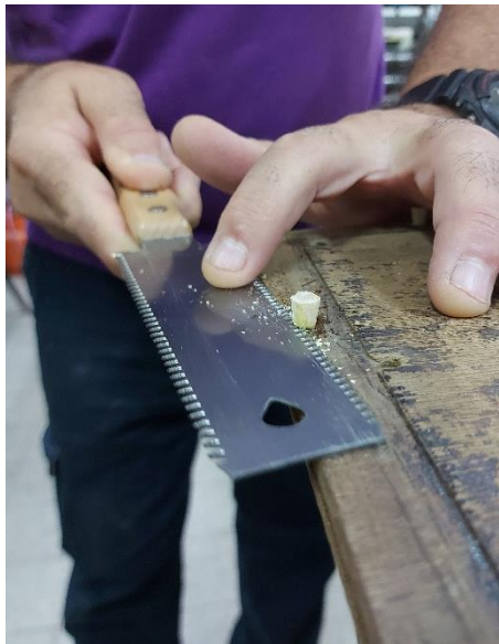
איור 19 – מימין לשמאל, מראה הלקונה\חור לאחר ניקיון, החדרת פין תותב מעץ במבוק והדבקתו, ניסור הפין לגובה פני השטח לאחר ייבוש הדבק
