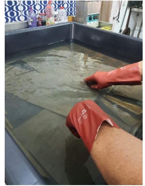
איור 13 – מימין לשמאל, הכנסת לוחות התבליט הירקרקות לאמבט התמיסה ומראה פני השטח המשתנים באיטיות ועליהם נחשפים ומתגלים פרטי התבליט עקב הסרת מלחי הקורוזיה.
