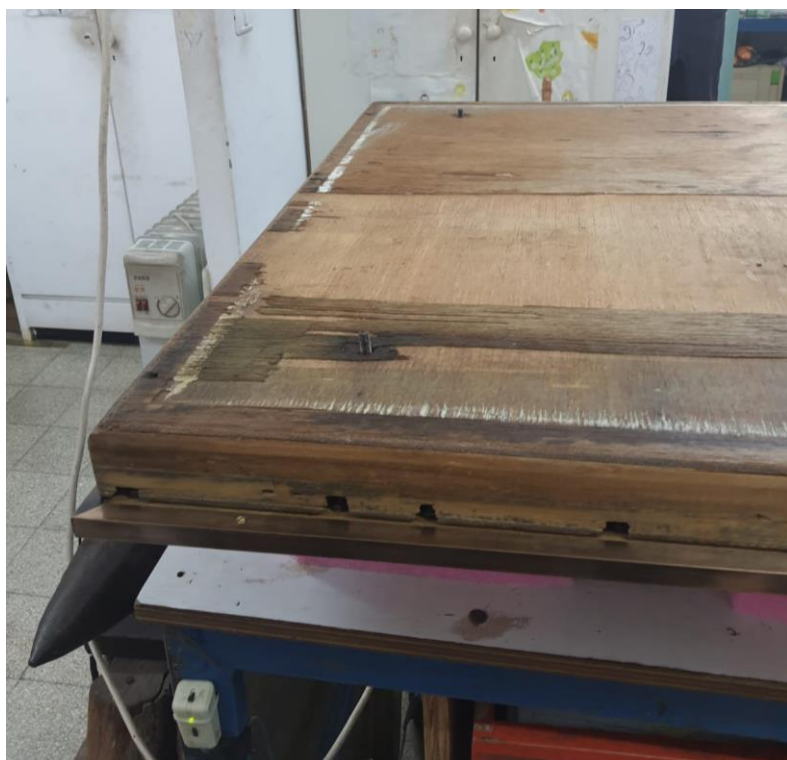
איור 15 – ימין, הנחת שכבת ציפוי מגן על העץ. שמאל, מראה החלק האחורי של הדלת בו נראה גוף העץ לאחר הנחת הלכה ואזורי הדבקת הפורניר
