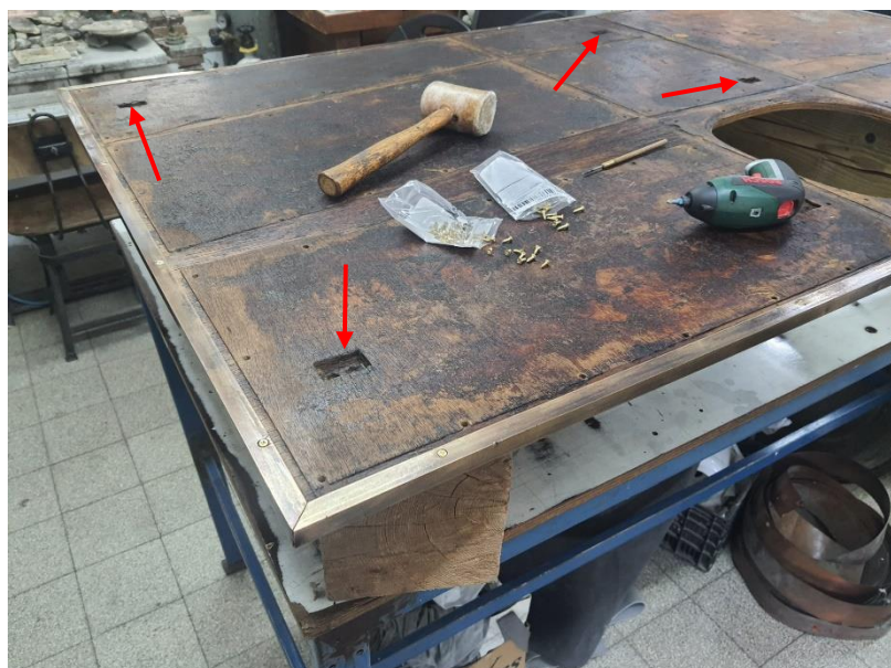
איור 22 - ימין, מבט מקרוב על הבליה הרבה בפיני הברזל. שמאל, מבט על לוח העץ הלבד, מסגרת פרופיל הפליז וגומות הפינים
