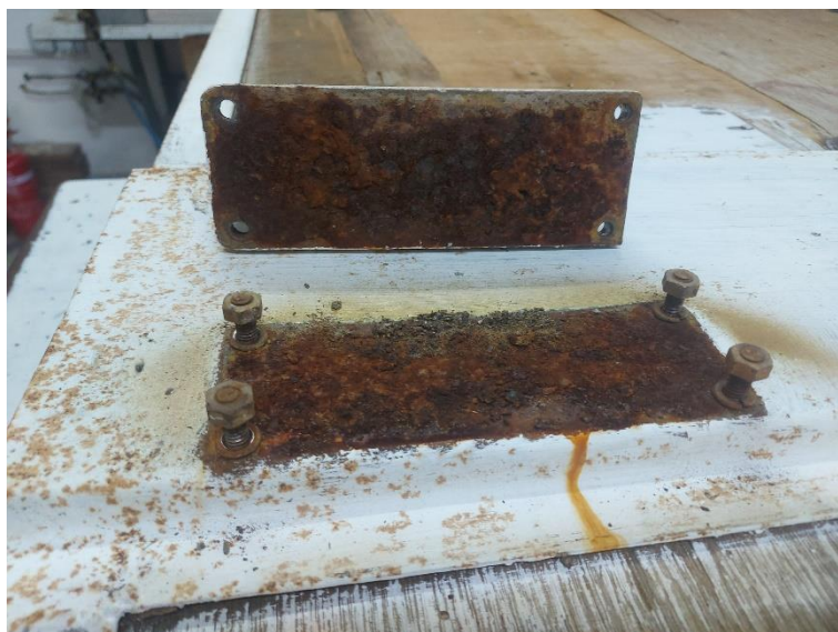
איור 11 – מבט מקרוב על פני השטח החיצוניים של המסגרת הברזלית, החלודה הרבה ונזקיה, פנים המסגרת היה חלוד אף יותר כפי שאפשר ללמוד מהלכו הרב ואבדן חומר מקור שנראה באיור 9.
