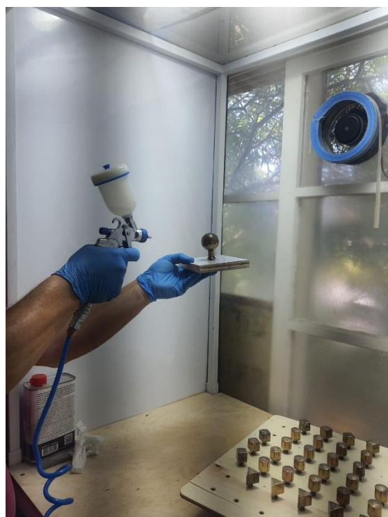
איור 17 – ימין, התזת ציפוי מגן מבוקר בחדרון הצביעה. שמאל, התזת שכבה שנייה על מכלול חלקי נתכי הנחושת
