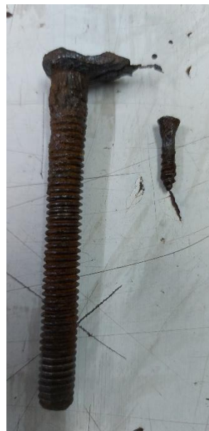
איור 22 - ימין, מבט מקרוב על הבליה הרבה בפיני הברזל. שמאל, מבט על לוח העץ הלבד, מסגרת פרופיל הפליז וגומות הפינים
