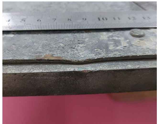
איור 4 – ימין, מבט מקרוב על המכה בפח. שמאל, מראה זווית הקימוט ביחס לסרגל
