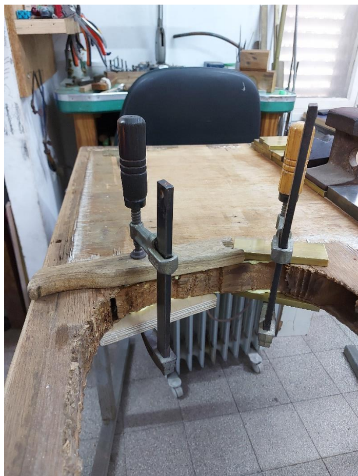
איור 14 – ימין, הדבקת שכבות גוף הדלת מהעץ וכליבתן. שמאל, משקולות על שכבת הפורניר לאחר החדרת דבק בעזרת מזרק
