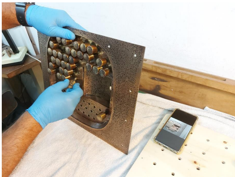
איור 25 – ימין, הרכבת מכלול חלקי הידית למקומם המקורי. שמאל, מראה הדלת עם מכלול הידית
