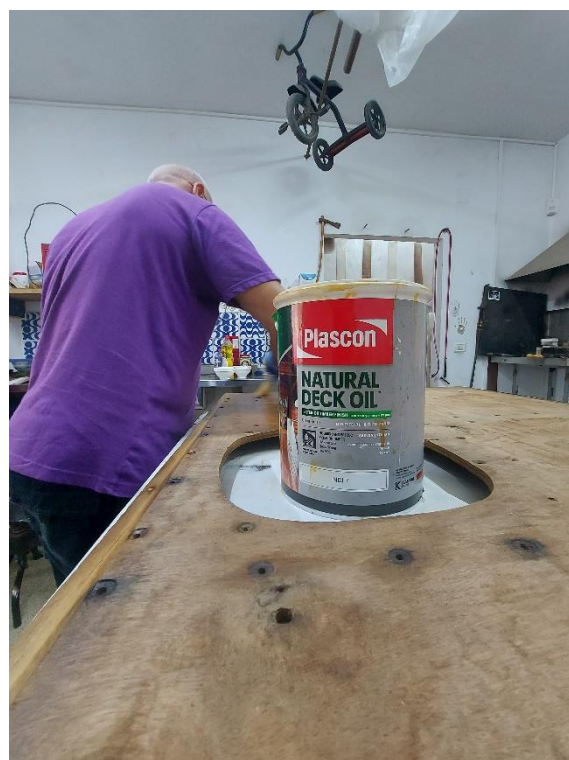
איור 15 – ימין, הנחת שכבת ציפוי מגן על העץ. שמאל, מראה החלק האחורי של הדלת בו נראה גוף העץ לאחר הנחת הלכה ואזורי הדבקת הפורניר
