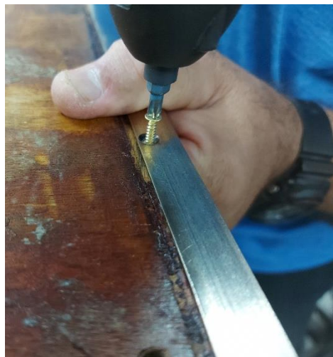
איור 20 – מימין לשמאל, מרכז חור ההברגה בתותב בעזרת דקר, הברגת בורג עץ חדש מפליז, מראה מקרוב של הבורג המהדק את מסגרת פרופיל הפליז לעץ הלבוד.
